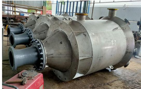
Condensadores Barométricos fabricados en
